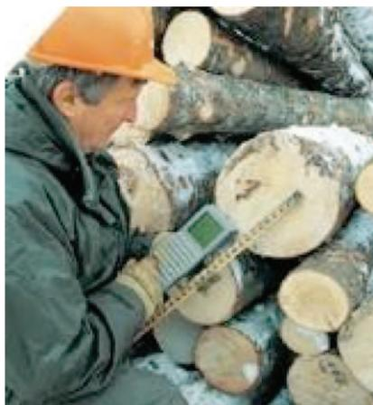
Figure 2. Un technicien en train d'analyser la qualité d'une bille de bois
