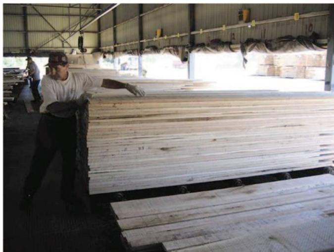
Figure 5. Tri des planches après le sciage
